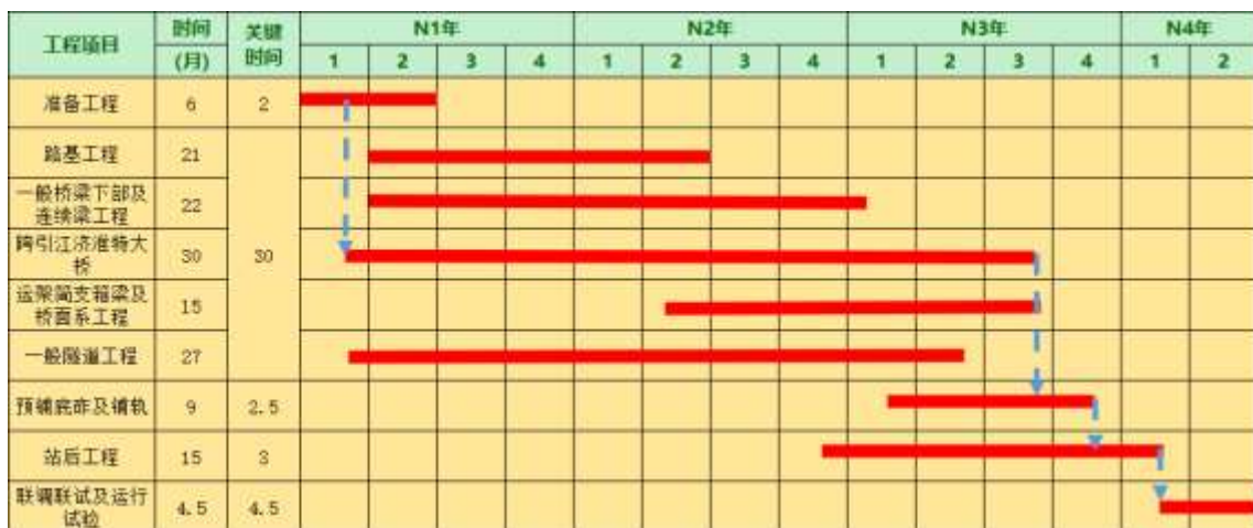
图 2.1-14 本工程施工进度计划横道图
